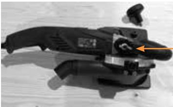
3) Lockern Sie die Flügelmutter des Bügelgriffs und drehen diesen nach oben bis er fast senkrecht steht. Schrauben Sie die Flügelmutter wieder fest.
