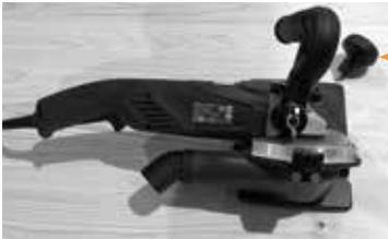
2) Entfernen Sie den Knauf von der Hobelsohle indem Sie diesen gegen den Uhrzeigersinn drehen.
