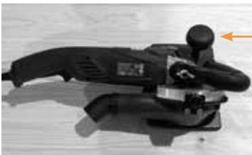
4) Montieren Sie den Knauf auf die Hobelsohle indem Sie diesen im Uhrzeigersinn festdrehen.
